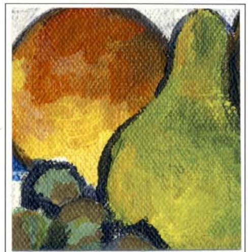
1600 Stunden UV-Bestrahlung GOLDEN Gel Topcoat w/UVLS
