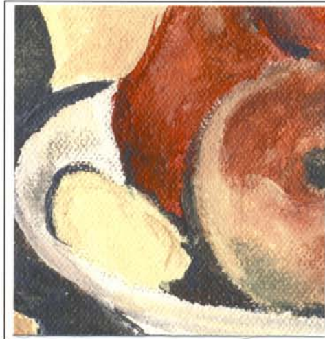
1600 Stunden UV-Bestrahlung ungeschützt
